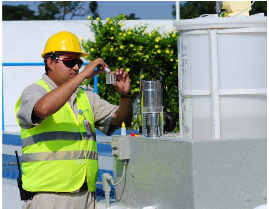
Pruebas de calidad de agua residual en el Aeropuerto de Veracruz
